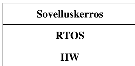
Kuva 2.1. Sulautetun reaaliaikajärjestelmän kerrosrakenne.
