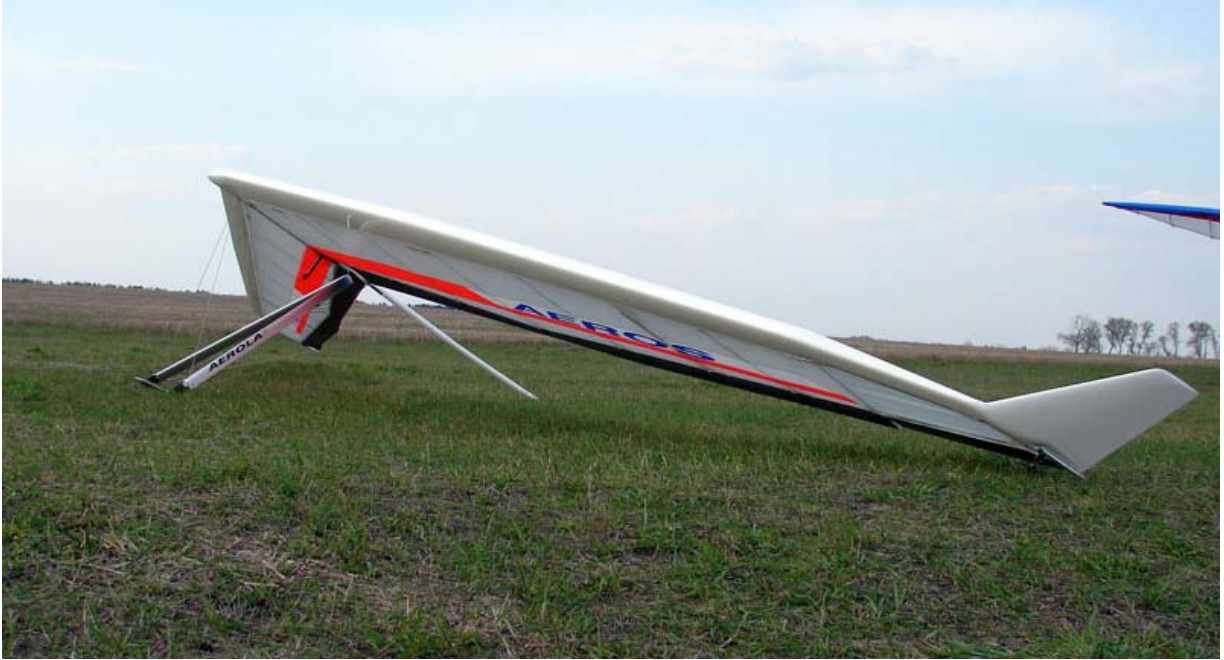
Kuva 3.4. Aeros Phantom – kiinteäsiipinen, aerodynaamisilla ohjauspinoilla varustettu riippuliidin / Aeros Ltd
